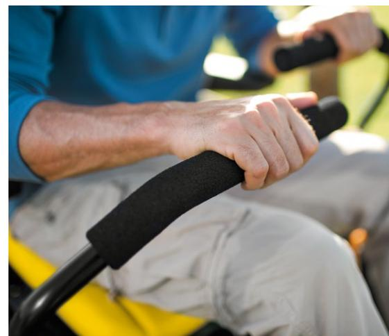
**Svolte immediate:** le leve di comando del movimento sono regolabili in due diverse posizioni di altezza e diciotto diverse posizioni longitudinali, per offrire più comodità all'operatore e garantire un controllo ancora più preciso.
