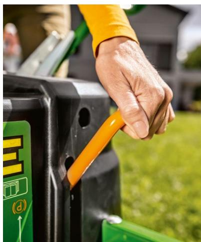
**Freno di stazionamento:** il freno di stazionamento è posizionato a portata di mano ed è estremamente efficace nel mantenere la macchina in posizione di parcheggio, persino sui terreni in pendenza.
