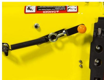
Per utilizzare il cesto raccogliërba posteriore Power Flow™ con le lame per mulching e l'accessorio MulchControl™ installati, è sufficiente portare la leva nella posizione di scarico laterale.
