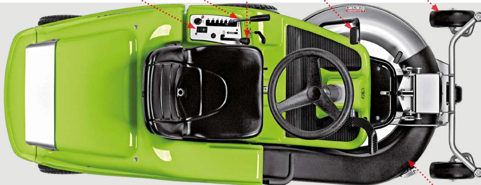
Il **freno di stazionamento** è a disco di tipo "attivo", cioè permette di scendere dalla macchina a motore in moto, purchè la funzione di taglio non sia inserita (massima sicurezza), e viene comandato da una pratica leva.
