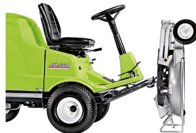
**Il piatto di taglio** di FD 280 è facilmente smontabile e si posiziona stabilmente in posizione verticale grazie ad appositi supporti integrati nella scocca; è sufficiente scollegare la cinghia di trasmissione con un comando rapido e si può accedere ad ogni tipo di ispezione e manutenzione.
