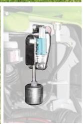
Sistema automatico di stabilità che gestisce il bloccaggio e lo sbloccaggio del differenziale.
