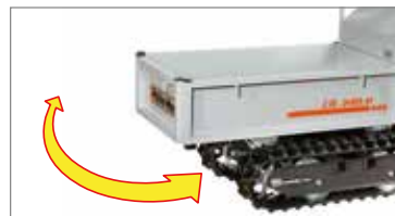
Raggio di sterzata ridotto per muoversi agevolmente nei cantieri o in mezzo a serre e vigneti.
