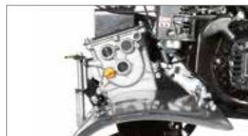
Trasmissione ad ingranaggi in bagno d'olio, resistente e con limitata manutenzione.
