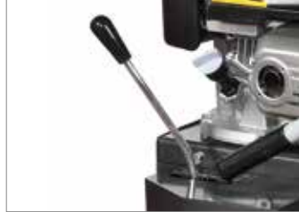
Comando selettore delle velocità con leva.
