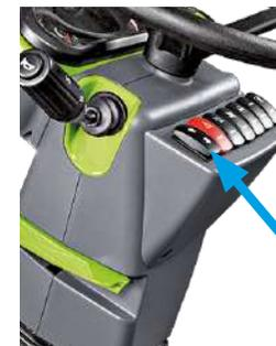
La regolazione dell'altezza del piatto semplice e precisa, è idraulica e si effettua tramite un pulsante sul cruscotto del volante, questo permette di regolare agevolmente e in continuo **senza scendere dal posto di guida**.
