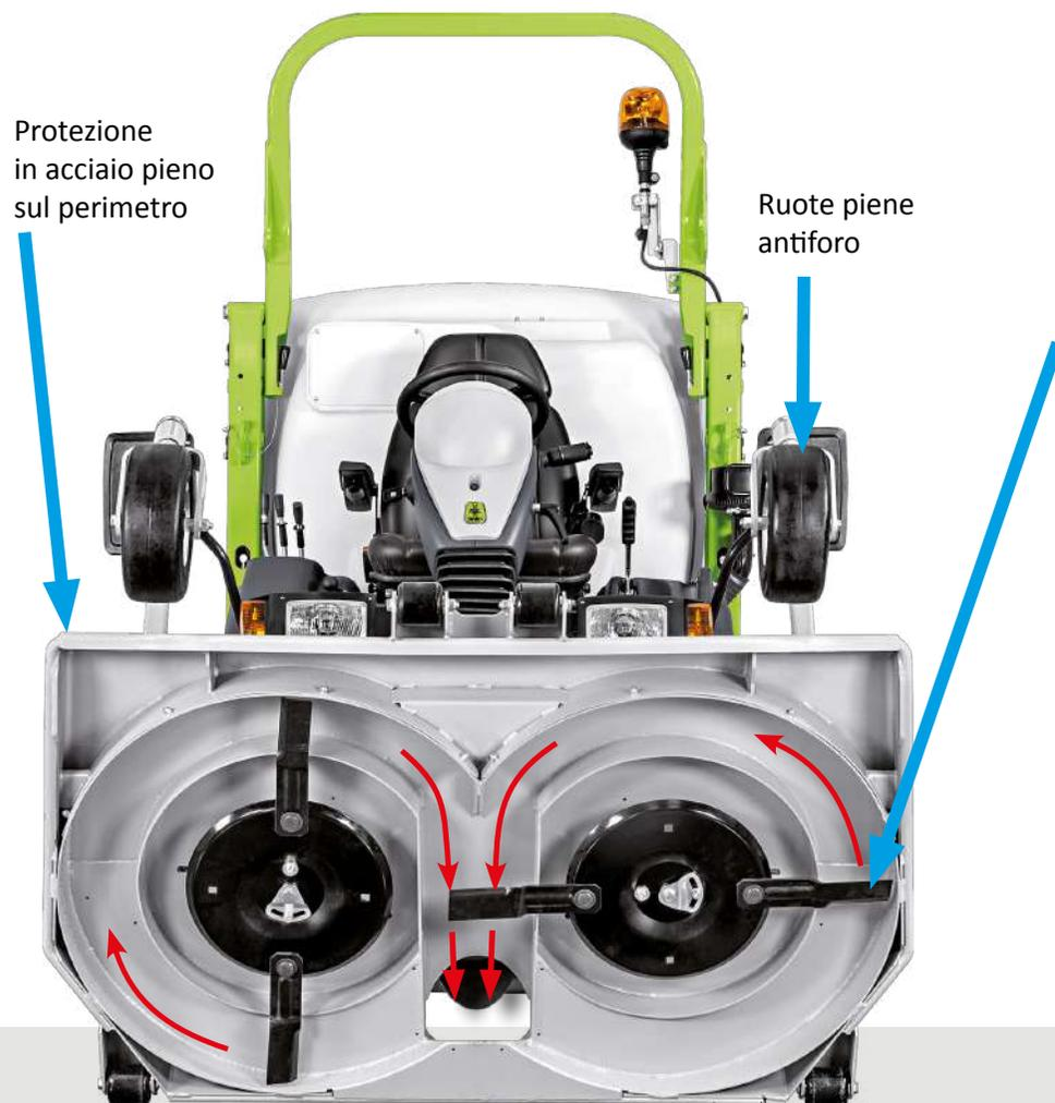
Le lame sono montate su dischi ed hanno il terminale rientrante antiurto in modo che la trasmissione sia sempre protetta dai sovraccarichi dovuti agli impatti contro ostacoli nascosti.
