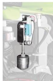
**Sistema Automatico di Stabilità** che gestisce il bloccaggio e lo sbloccaggio del differenziale quando necessario (oltre che manualmente).
