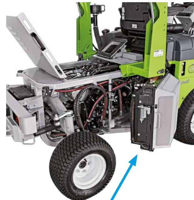
**Il gruppo radiatore si apre verso l'esterno** per facilitarne l'ispezione e la pulizia ed è dotato di un **sistema automatico di inversione del flusso della ventola** che mantiene pulita tutta la superficie della griglia e garantisce un controllo costante della temperatura.
