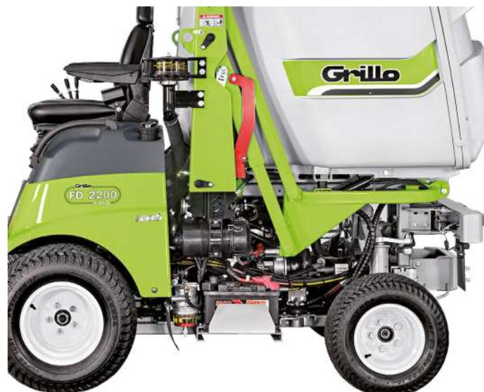
È facile accedere al prefiltro, al filtro aria motore, al filtro e al decantatore gasolio e ai filtri olio idraulico. Anche la batteria è comodamente raggiungibile così come il tendicinghia e la frizione elettro idraulica della PTO. Anche l'accesso posteriore agli organi idraulici come la pompa variabile e le pompe dei servizi è semplice.
