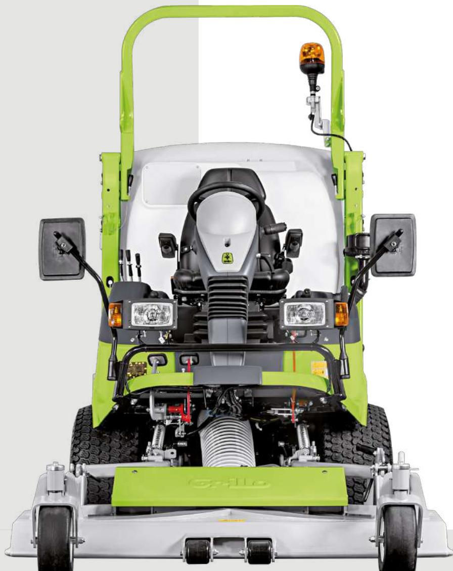
**L'innesto PTO è indipendente** da quello della turbina di raccolta.
