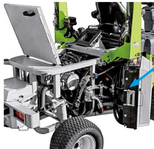
L'accesso al vano motore è facile. **I punti di ingrassaggio** per la manutenzione ordinaria **sono evidenziati** da una etichetta vicina al posto di guida.
