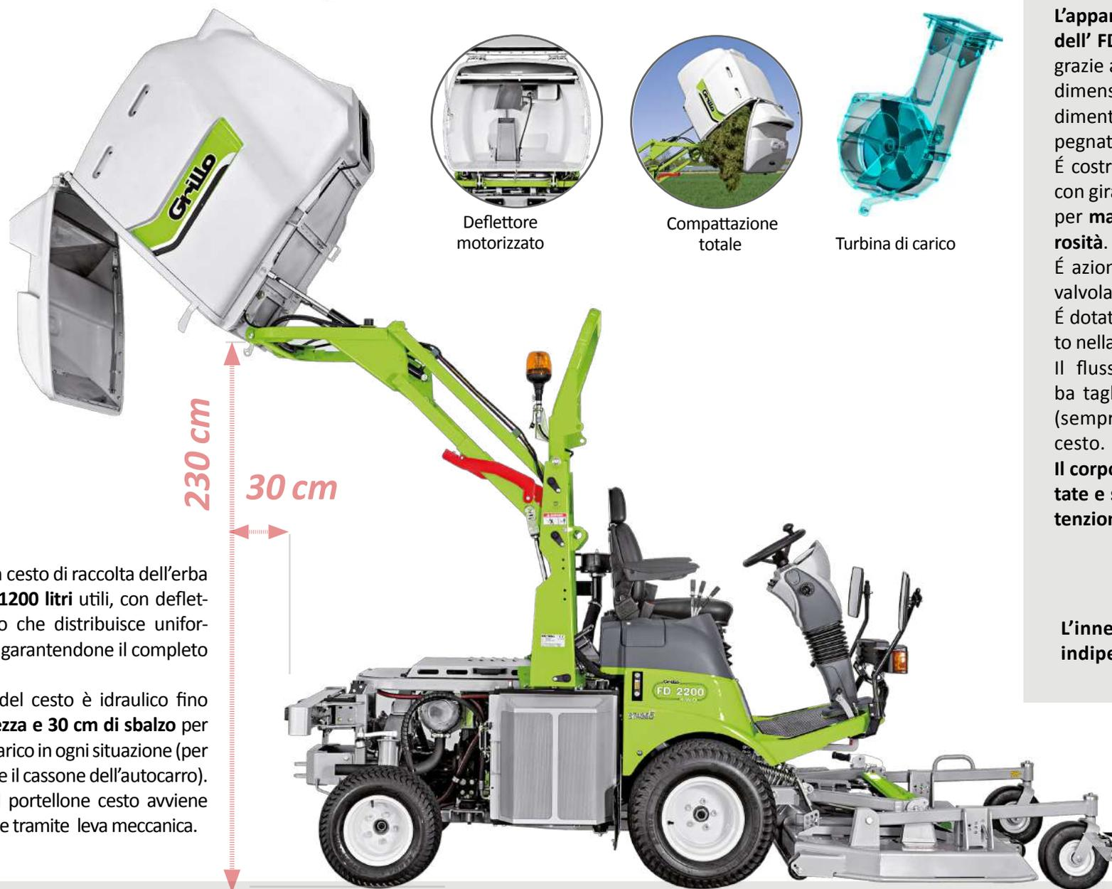
L' **FD 2200** ha un cesto di raccolta dell'erba con capacità di **1200 litri** utili, con deflettore motorizzato che distribuisce uniformemente l'erba garantendone il completo riempimento.
