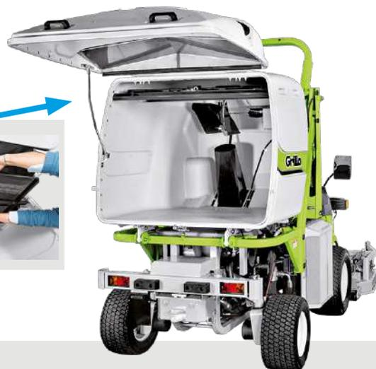
**È facile accedere** al prefiltro, al filtro aria motore, al filtro e al decantatore gasolio e ai filtri olio idraulico.
